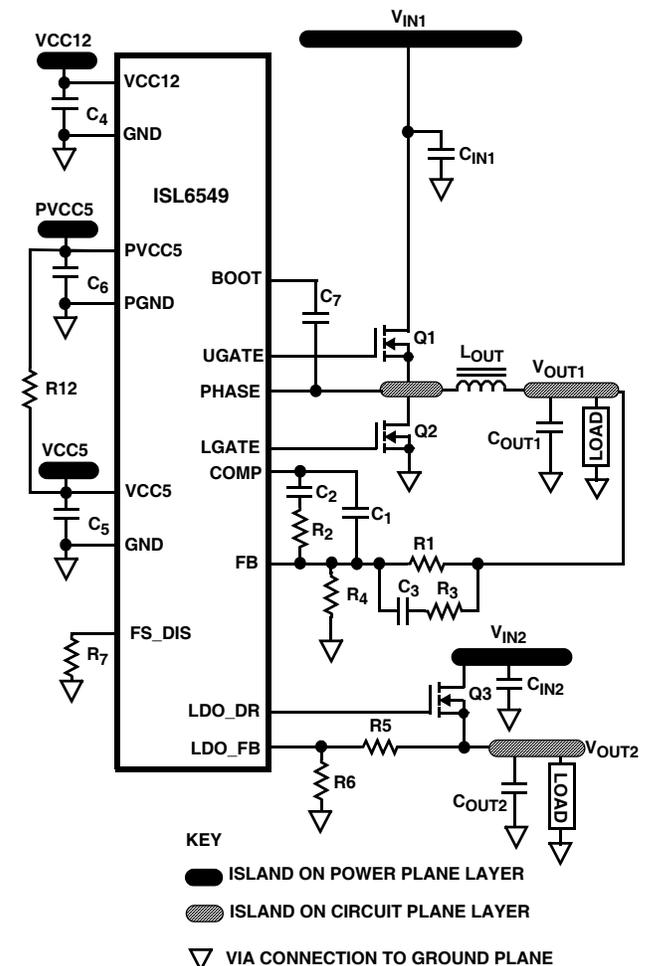
FIGURE 13. PRINTED CIRCUIT BOARD POWER PLANES AND ISLANDS
