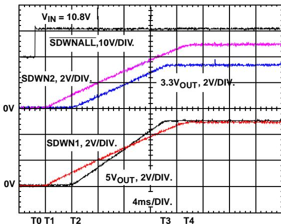
**FIGURE 7. SOFT START ON 3.3V AND 5V OUTPUTS**
